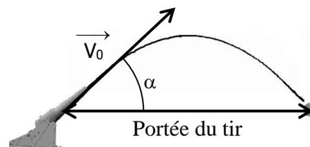
La portée du tir est donnée par la **fonction** :  $X(\alpha) = \frac{2(V_0)^2}{g} \cos \alpha \cdot \sin \alpha$  avec  $g = 9,81 \text{ m/s}^2$
